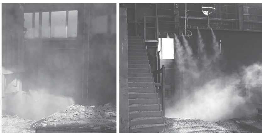
Hình 2. Hệ thống dập bụi phun sương trong nhà máy sàng tuyển, chế biến than [2]
