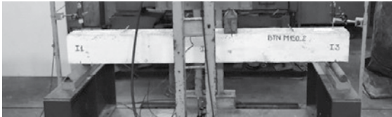
Hình 3. 9. Lắp dựng dầm và thiết bị thí nghiệm
