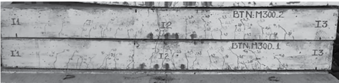
Hình 3. 11. Phân bố các vết nứt trên dầm BTN và dầm BTT
