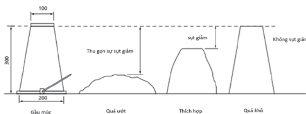
Hình 7. Kiểm tra độ sụt bê tông
