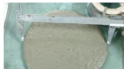
Hình 3. Trộn và thí nghiệm độ chảy xòe hỗn hợp UHPC
