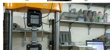
Hình 4. Thí nghiệm cường độ chịu nén và kéo mẫu UHPC
