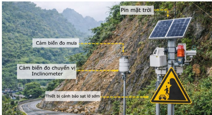
Hình 4. Ứng dụng cảm biến và hệ thống cảnh báo sớm trong giám sát chuyển vị mái dốc tại khu vực đồi núi
