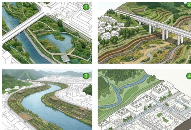
(1) Công viên ngập nước (2) Hành lang thoát lũ sinh thái (3) Kè sinh thái kết tạo không gian trữ nước cho sông (4) Các giải pháp SuDS quy mô nhỏ: Mái nhà xanh, vườn thu nước mưa, hệ tự thấm
